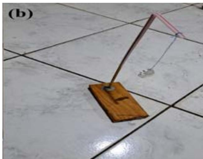
**Figura 1(b):** Eletroscópio de Pêndulo. Autoria Própria (2023).
