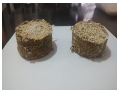
Figura 1. Briquete prensado. Fonte: Próprio autor (2023).
