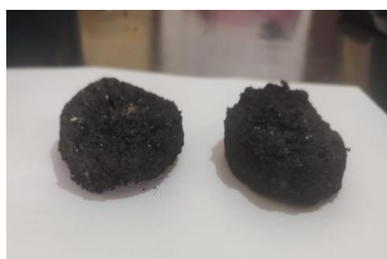
Figura 2. Carvão formado a partir da pirólise dos briquetes prensados. Fonte: Próprio autor (2023).
