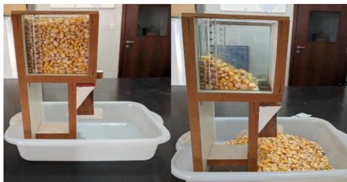
Figura 1. Equipamento utilizado para a determinação do ângulo de repouso, e grãos formando o talude.
