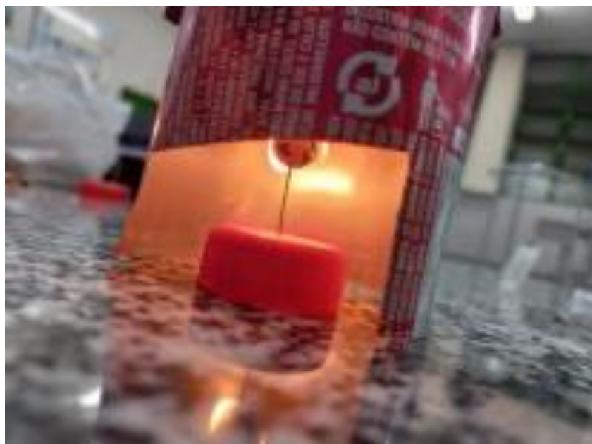
Figura 1- Queima do amendoim no calorímetro caseiro. Arquivo pessoal (2022).
