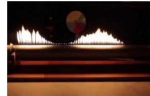
FIGURA 1: Tubo de Rubens em funcionamento Fonte: Elaborado pelos autores (2022)
