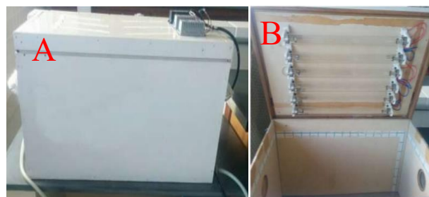
Figura 2 – Fotorreator usado na reação de esterificação. (A) reator, (B) reator aberto mostrando o local da posição das lâmpadas.
