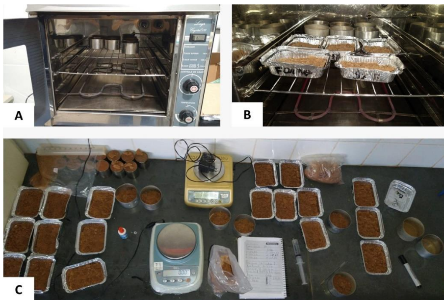
Figura 1: Determinação da Umidade gravimétrica do Solo pelo Método do Forno Elétrico. Forno Elétrico Marca Layr, modelo Crystal 1.75 (A); Amostras de solo inseridas no forno pré-aquecido a 160°C (B); Amostras de solo prontas para pesagem após secagem no forno elétrico (C).
