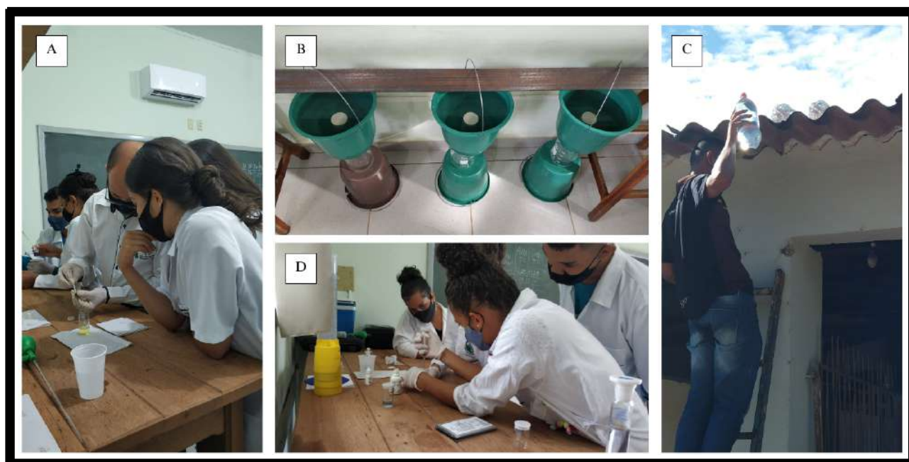
Figura 1: Análises laboratoriais físico-químicas de água (bruta e tratada) coletada em reservatório do programa cisternas situado no município de Januária-MG. Análises de Cloretos (A); Filtragem por vela cerâmica (B); Desinfecção da água pelo método SODIS (C); Análises com auxílio do kit de potabilidade Alfakit.
