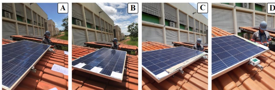
Figura 2. Ensaios. Fig. 2A. Módulo limpo. Fig. 2B. Três células sombreadas. Fig. 2C. Sujeira na horizontal. Fig. 2D. Sujeira na vertical. Acervo próprio (2023).
