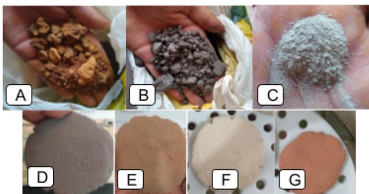
**Figura 1.** Amostras de argila provenientes de Cônego Marinho (A), Bonito de Minas (B) e argila cinza (C) antes do processamento; mistura contendo amostra de Bonito de Minas (D) e amostra de Cônego Marinho (E) após a secagem, e; mistura contendo amostra de Bonito de Minas (F) e amostra de Cônego Marinho (G) após a queima. Fonte: Arquivo Pessoal (2021).
