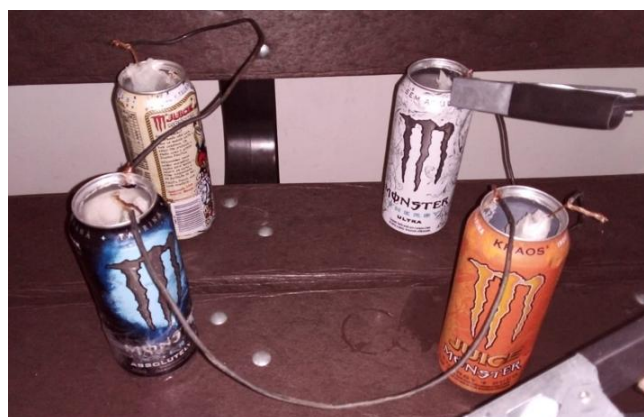
Figura 1: Células eletroquímicas produzidas com materiais de baixo custo.
